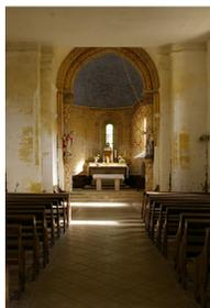
L'église SAINTE-MADELEINE mesure intérieurement 25 m de longueur, 6,70 m de largeur dans la partie postérieure et 5 m au niveau du chœur. Les murs mesurent jusqu'à 1,60 m d'épaisseur. Elle comporte quatre travées. Les deux travées près du chœur sont d'origine.
